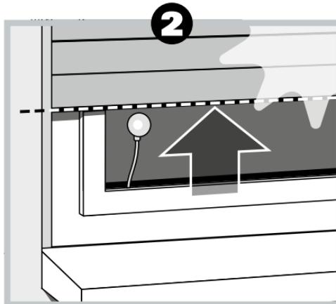
freizugeben. Bei weiterer Sonneneinstrahlung bleibt der Rollladen in dieser Position stehen. Fällt die Helligkeit unter den eingestellten Grenzwert, fährt er bis zum oberen Endpunkt zurück.
