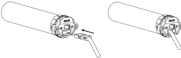
Zur Demontage der Steckerleitung die Steckerleitung spannungsfrei schalten. Die Verrastung des Steckers durch die seitliche Öffnung am Motorkopf lösen. Dies kann mithilfe eines Schraubendrehers oder einer speziellen Lösehilfe erfolgen. Bei gleichzeitigem Drücken auf den Verrastungsclip vorsichtig an der Steckerleitung ziehen, bis sich der Stecker löst und die Steckerleitung herausgezogen werden kann.
