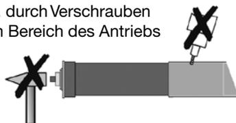
4. Die Welle mit dem Antrieb und der Wellenkapsel in den Lagern befestigen. Die Motorleitung nicht knicken und so verlegen, dass keine Schäden an der Leitung entstehen können. Um zu verhindern, dass Wasser in den Motor läuft, die Motorleitung in einem Bogen nach unten verlegen, damit Fließwasser abtropfen kann.
