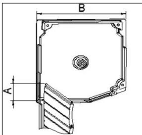
Der oberste Profilstab des Rollladens sollte nicht mehr als 1/2 der Profilhöhe aus der Führungsschiene herauskommen (A).
