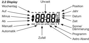
Der Selvetimer Plus steuert den Antrieb morgens und abends zu den programmierten Schaltzeiten oder abends zur Astrozeit (Sonnenuntergangszeit). Zusätzlich ist ein Lichtsensor anschließbar, was die Steuerung über Lichtwerte möglich macht. Über Nebenstelleneingänge (modellabhängig) können Gruppen- und Zentralsteuerungen aufgebaut werden. Eine manuelle Bedienung ist jederzeit möglich.
